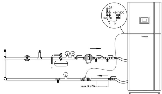
Abbildung 14: Einbau Durchflusssensor WQA-Sole
