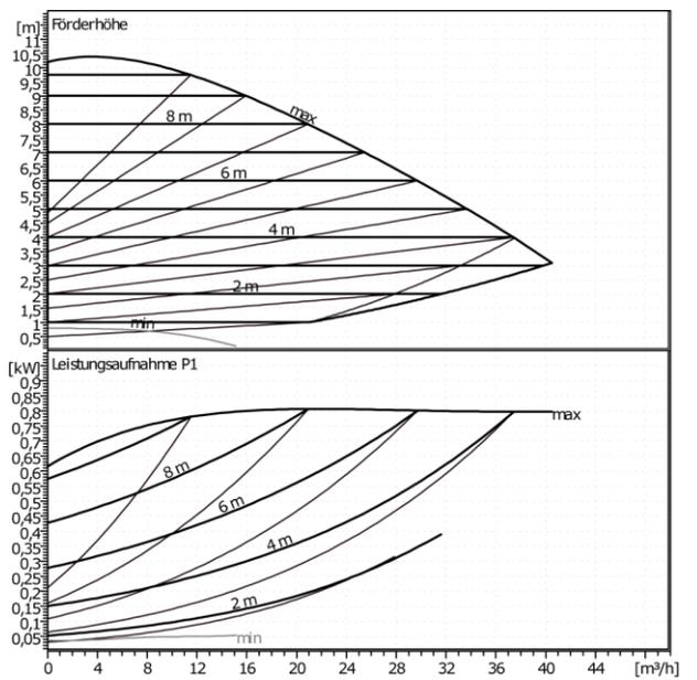
Abbildung 21: Pumpenkennlinie Stratos Para 65/1-12
