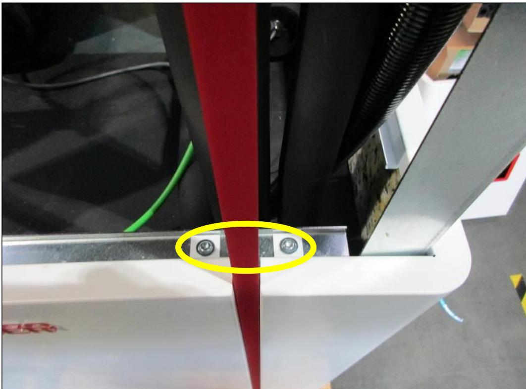
3 Schrauben links vorne laut Bild entfernen (Inbusschlüssel 4mm)
