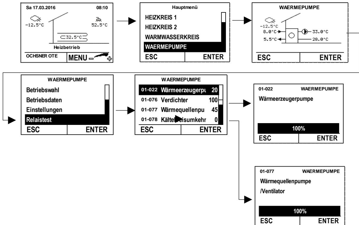
Abbildung 10: Wärmeerzeugerpumpe einschalten
