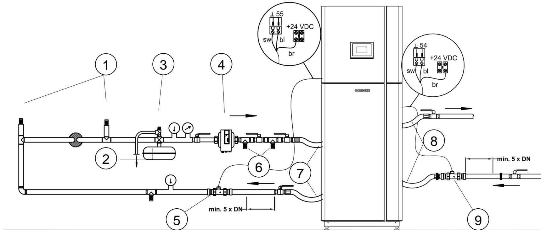
Abbildung 25: Anlagenschema Quellenergie Sole
