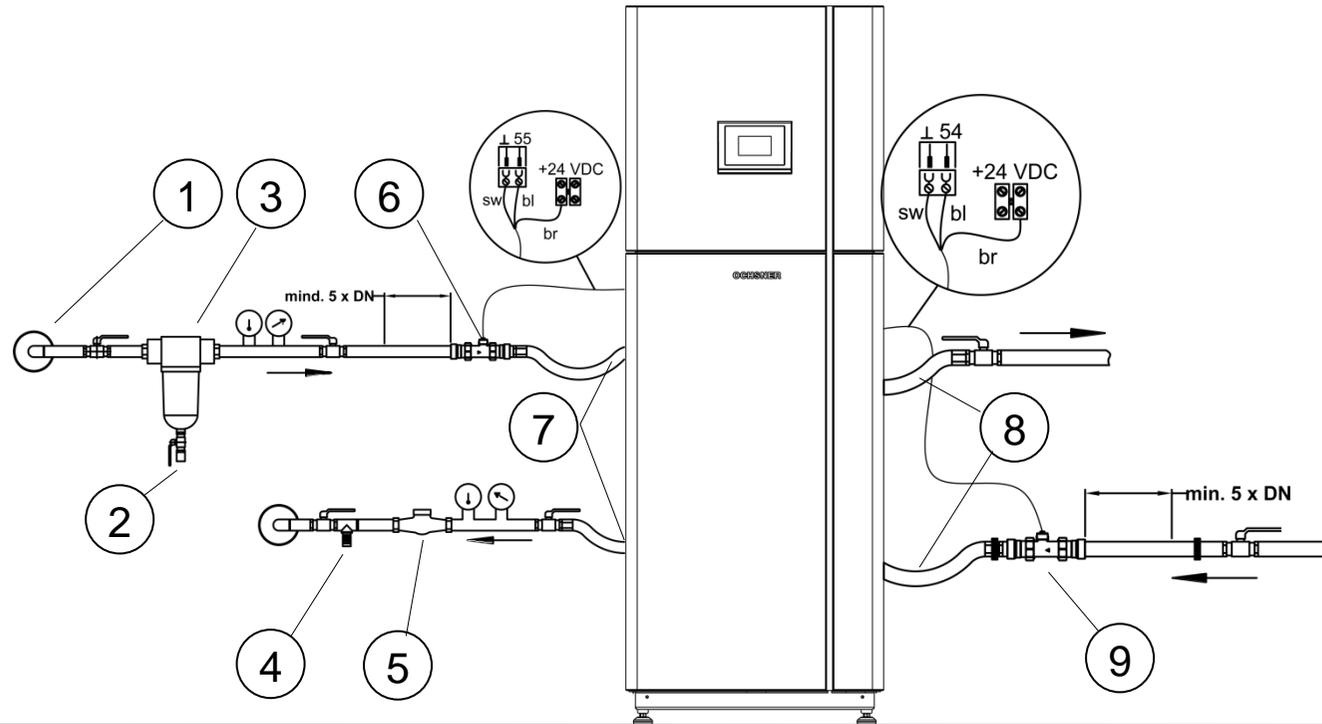
Abbildung 24: Anlagenschema Quellenergie Grundwasser
