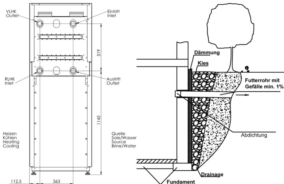
Abbildung 13: Mauerdurchführung
