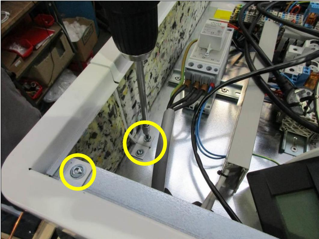
2 Schrauben laut Bild entfernen (Inbusschlüssel 4mm)
