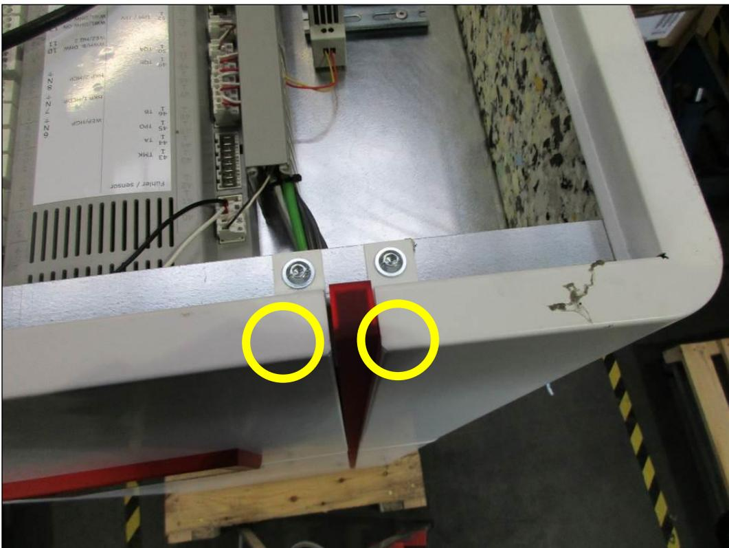
2 Schrauben auf der Rückseite entfernen (Inbusschlüssel 4mm)
