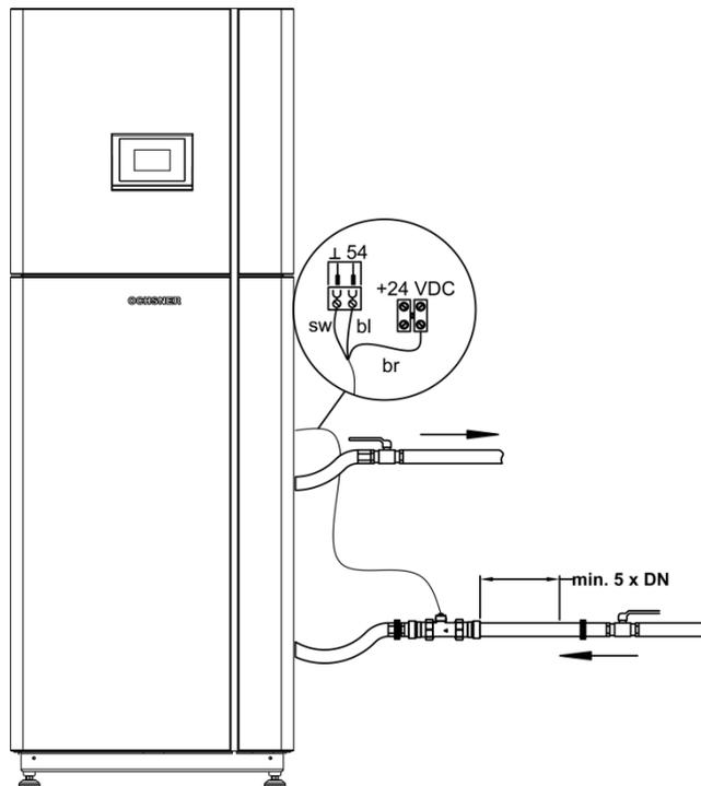
Abbildung 8: Durchflussmessung WNA
