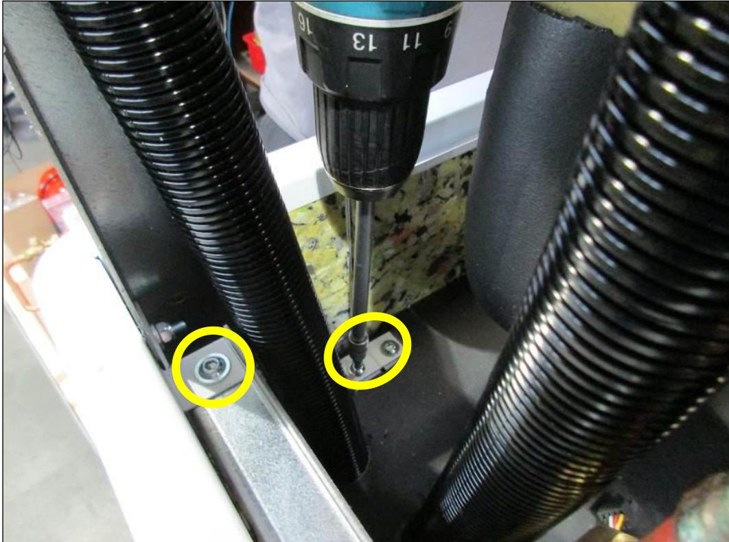
2 Schrauben auf der Rückseite laut den Bildern entfernen (Inbusschlüssel 4mm)
