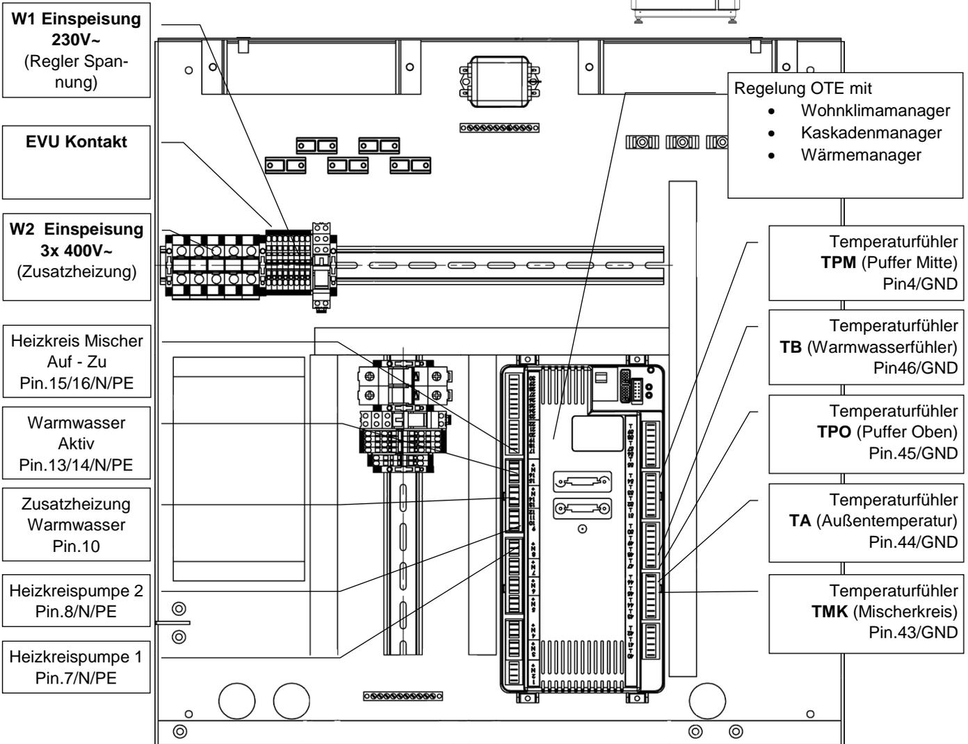
Abbildung 6: Verkabelung Schaltkasten TERRA Grundaufba
