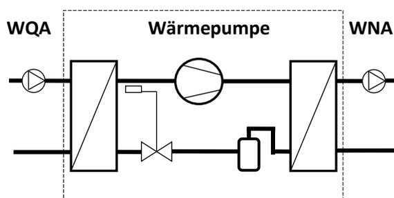
Abbildung 1: Kältekreislauf
