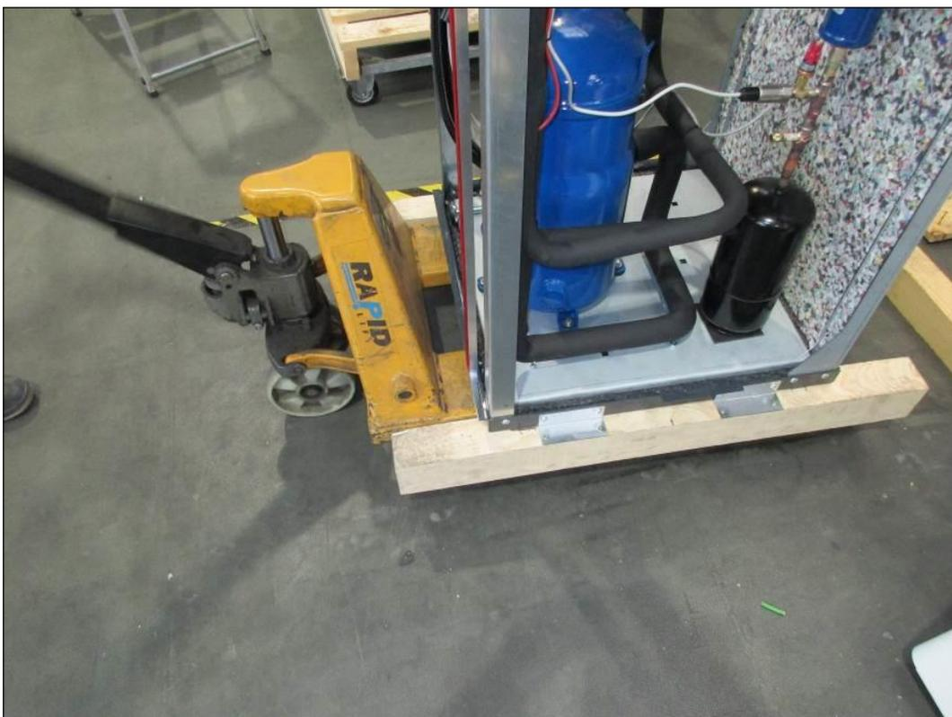
Die beiden seitlichen Holzbalken losschrauben (mit Gabelschlüssel gegenhalten)
