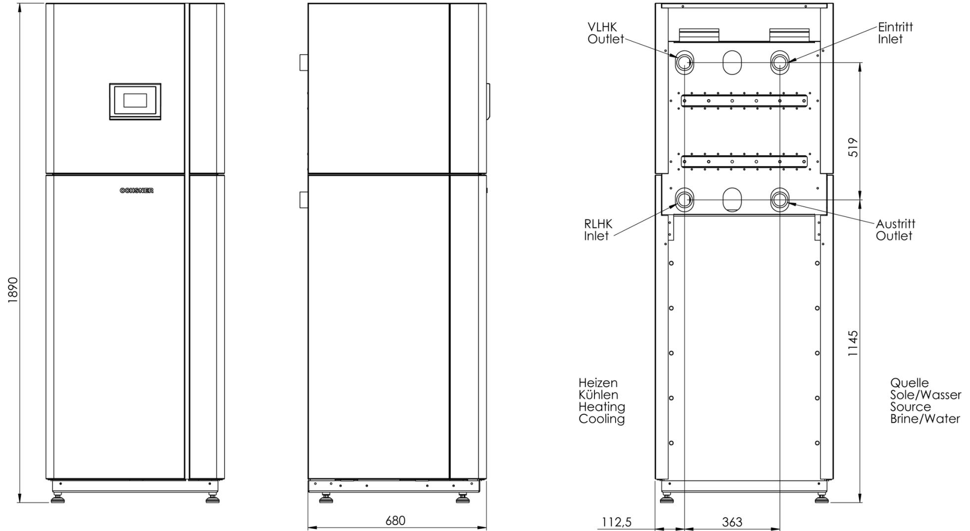
Abbildung 23: Abmessungen OCHSNER TERRA
