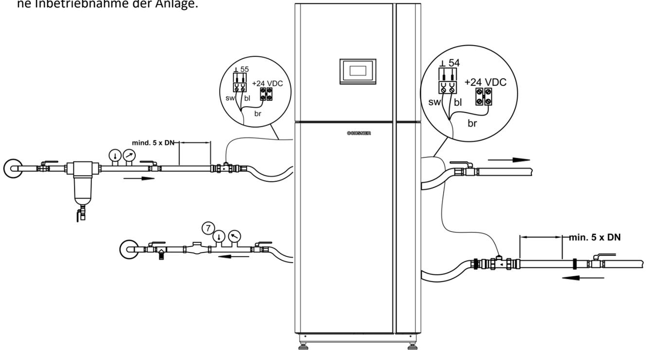
Abbildung 12: Einbau Durchflusssensor WQA – Grundwasser und WNA
