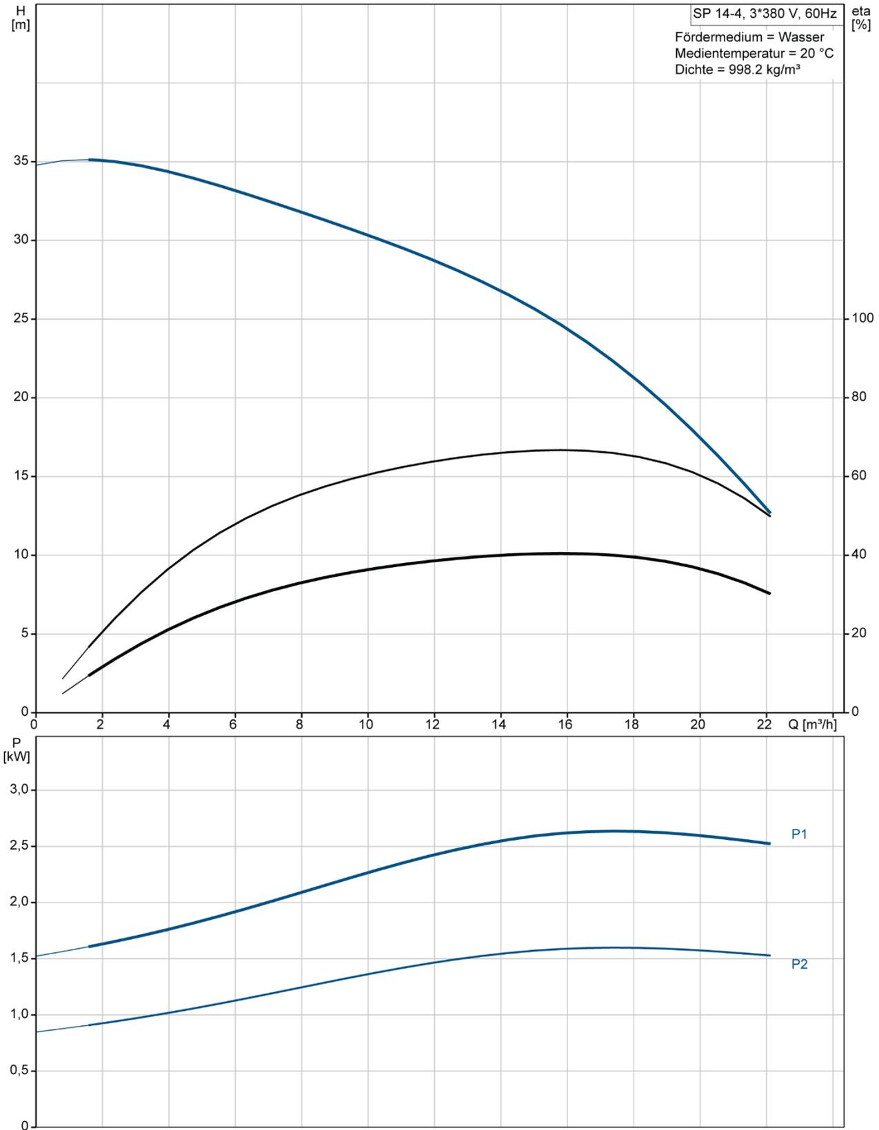
Abbildung 22: Pumpenkennlinie SP 14-4
