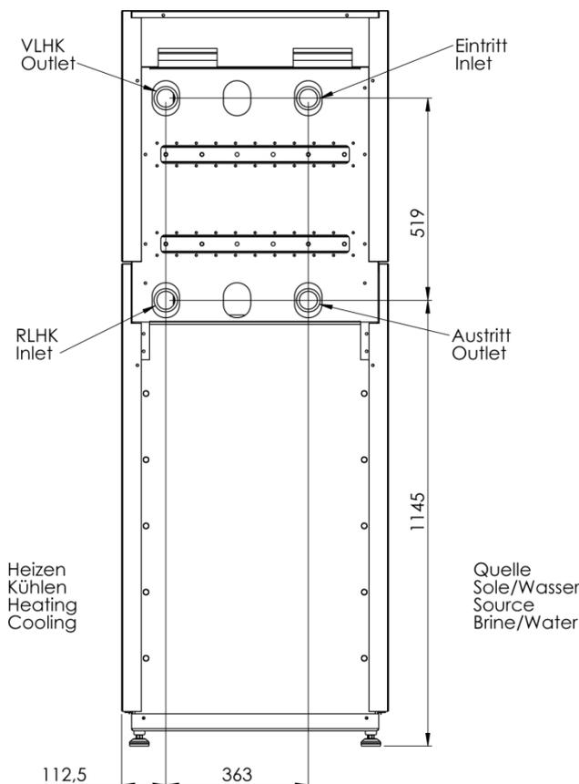
Abbildung 7: Hydraulischer Anschluss der Wärmepumpe
